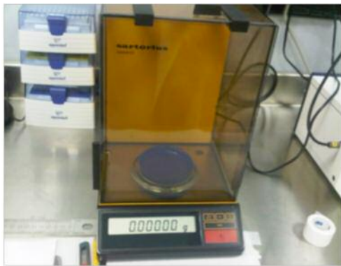
Figura 9: set-up sperimentale per la misura del peso dei campioni
