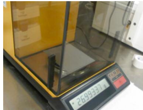
Figura 9: set-up sperimentale per la misura del peso dei campioni
