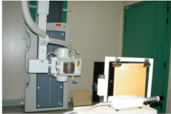
Figura 6: set-up sperimentale per la misura dell'attenuazione
